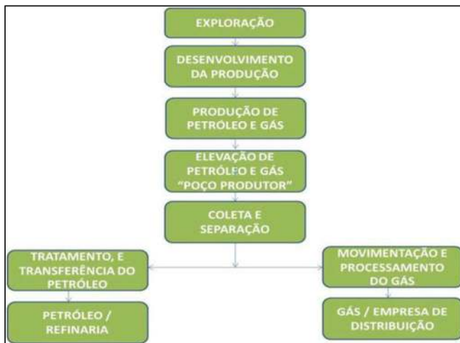
Figura 2 - Macrofluxo de um processo de Exploração e Produção de petróleo e gás (E&amp;P)
