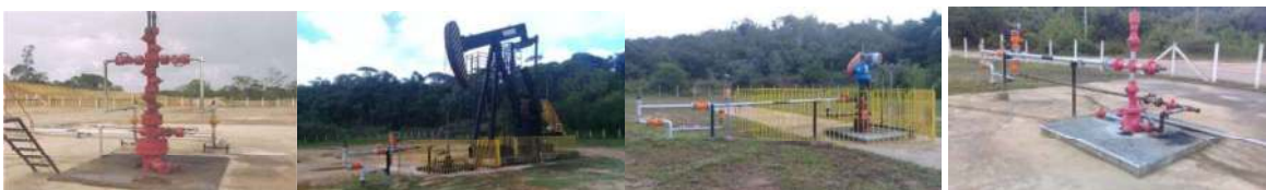
Figura 3 - Poço produtor de petróleo e de gás natural: Surgente / GL, BM, BCP e BCS
