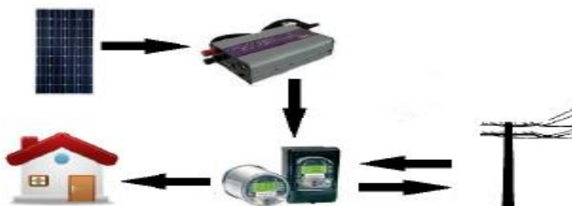
Figura 1 - Sistema fotovoltaico integrado à rede
