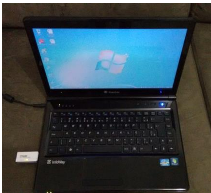
Figura 18: Um notebook com um modem 3G conectado a porta USB a esquerda da imagem, com o objetivo de captar o sinal da Internet.
