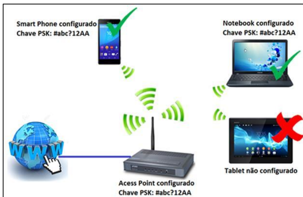
Figura 14: Rede sem fio com autenticação de chave pré-compartilhada. Fonte: Criada pelos próprios autores.
